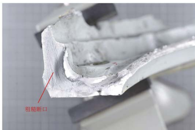
图 24、发动机中收集到的带螺栓孔的轮毂断裂碎块断面形貌
