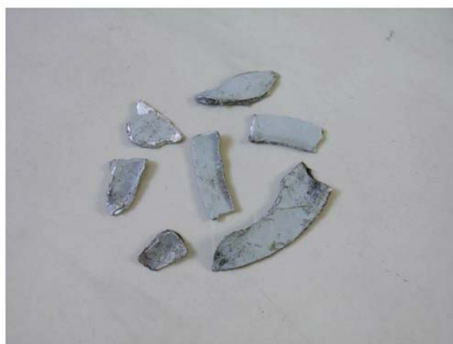
图 12、不能确定属于上述哪个轮毂的轮毂辐板碎片形貌
