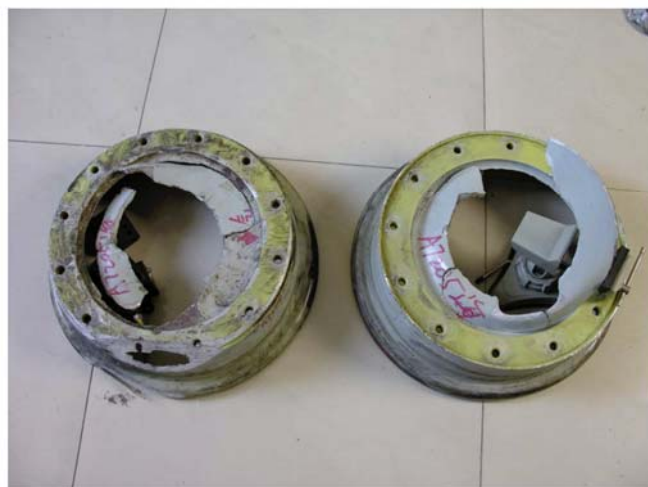
图 10、序列号为 A7205 的内、外半轮毂及确定属于这 2 个轮毂的辐板碎块形貌
