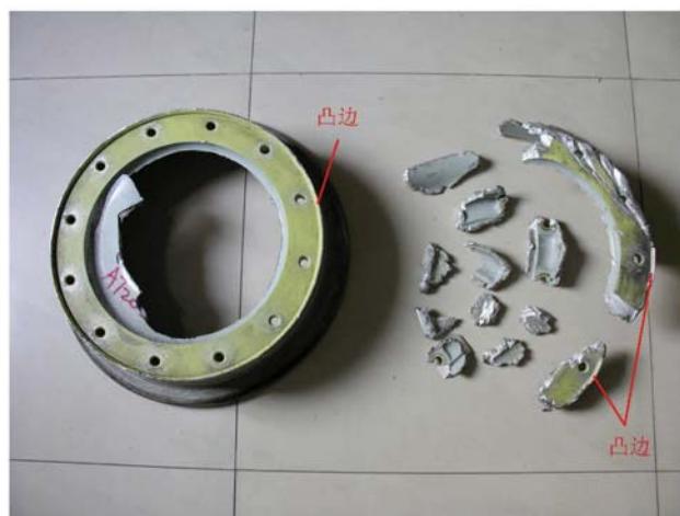
图 7、澳门机场跑道收集到的基本完整半轮毂和全部的半轮毂筒身断裂件形貌
