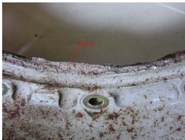
图 19、序号为 A7205 的内半轮毂辐板断口形貌
