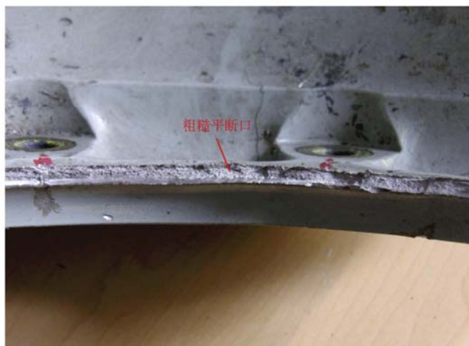
图 21、序号 A7205 外半轮毂毂辐板断口形貌
