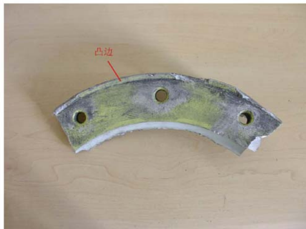
图 8、发动机中收集到的轮毂断裂碎块放大形貌
