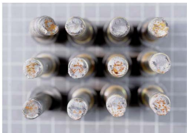
图 14、收集到的 12 根轮毂螺栓断口形貌
