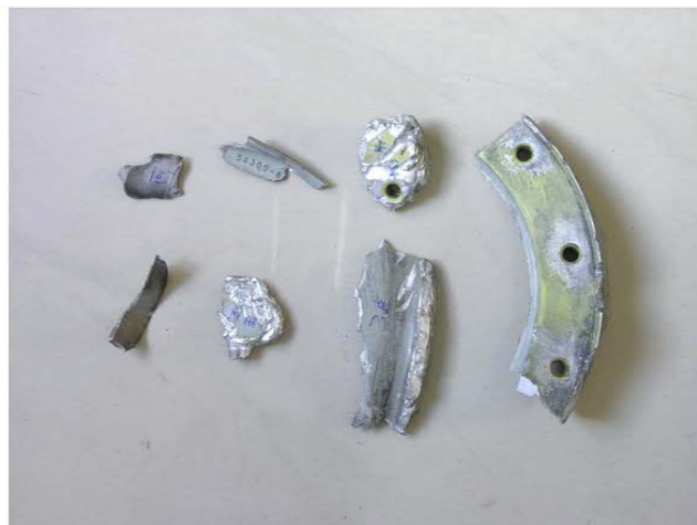
图 5、发动机中收集到的断裂部件形貌
