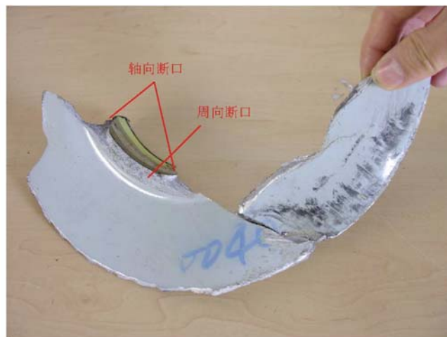
图 13、序列号为 A0040 的外半轮毂的一片带有部分中心毂圆筒的辐板碎块形貌
