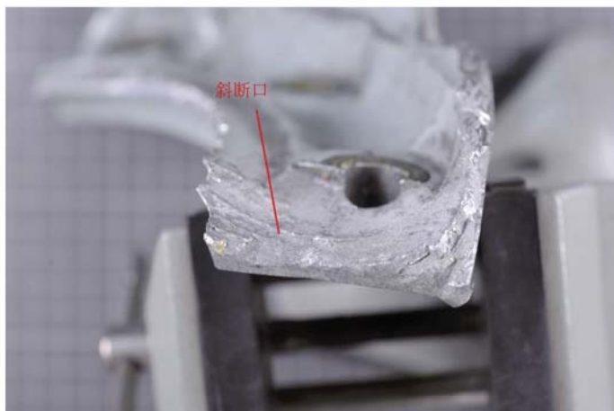
图 25、发动机中收集到的带螺栓孔的轮毂断裂碎块断面形貌
