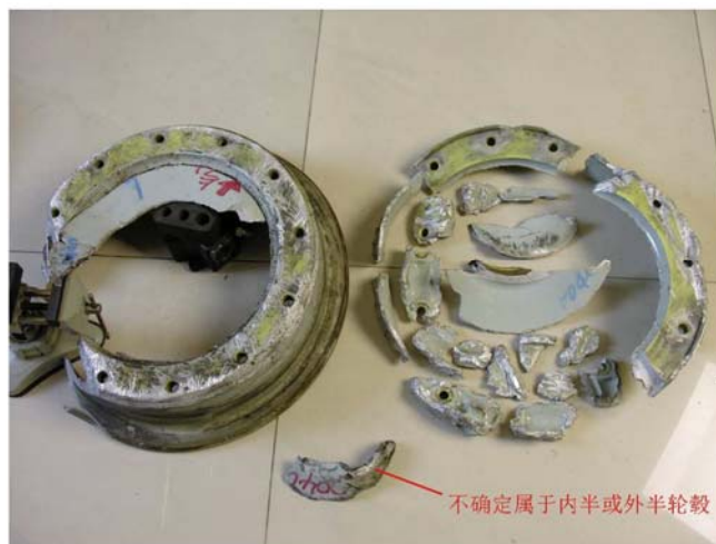
图 11、序列号为 A0040 的内、外半轮毂及确定属于这 2 个轮毂的辐板碎片形貌
