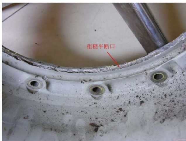
图 20、序号为 A0040 的内半轮毂辐板断口形貌
