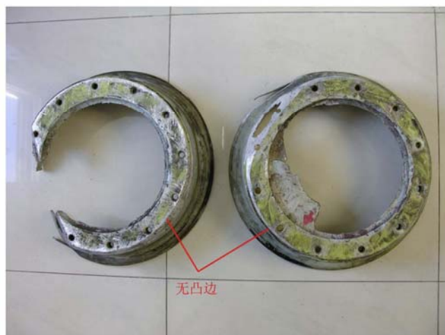
图 9、深圳机场跑道上收集到的两个半内轮毂放大形貌
