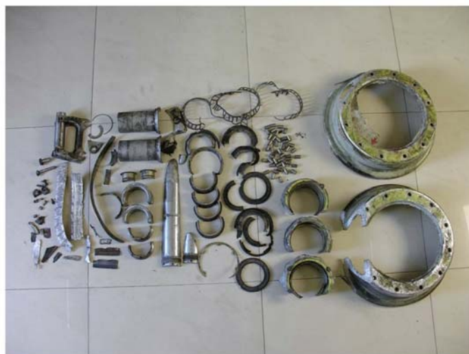
图 4、深圳机场跑道上收集到的飞机损伤部件形貌（部分零件角度不同）
